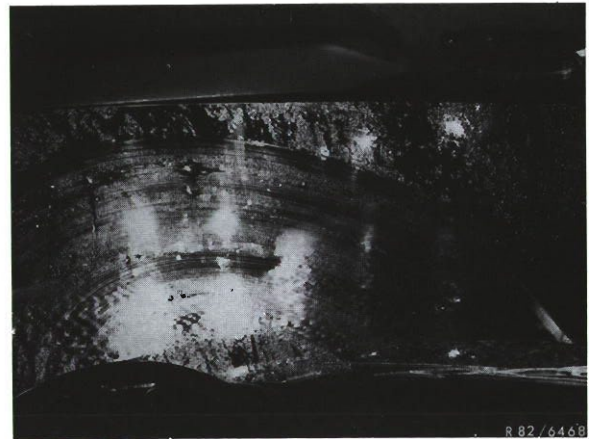
■ Wischbild mit abgenütztem Wischgummi oder verschmutzter Windschutzscheibe.
